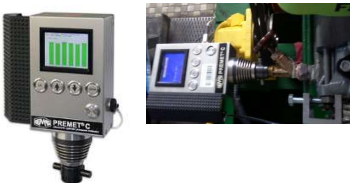
Rys. 3 Indykator elektroniczny LEMAG PREMETS® C. a) widok indykatora, b) indykator zamontowany na silniku Farymann Diesel D10
