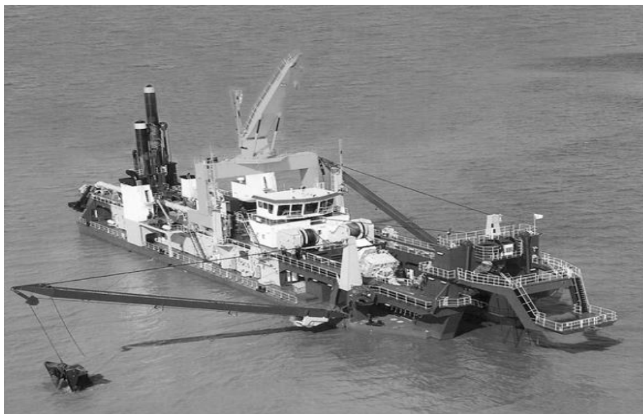
Rys. 1. Pogłębiarka frezująco-ssąca Al. – Mifra podczas przerzucania kotwic
