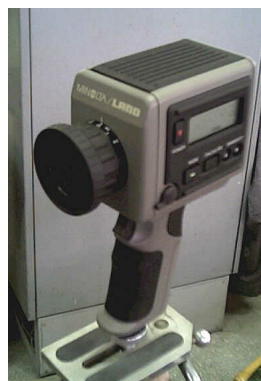
Fig. 2. Minolta/Land Cyclops 152A pyrometer
